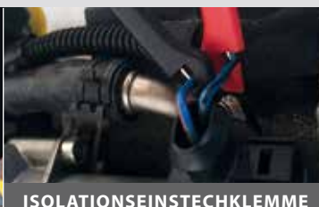
ISOLATIONSEINSTECHKLEMM MIT NADELPRÜFSPIITZE
