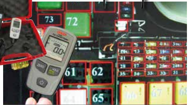
STROMSTÄRKENMESSUNG AM SICHERUNGSKASTEN
